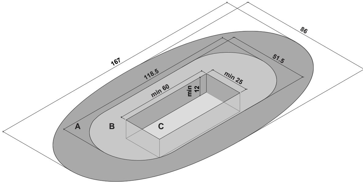
IT\_1\_ A= Ingombro esterno. B= Base d'appoggio. C= Dimensioni pozzetto
