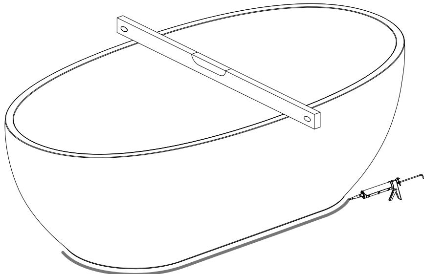
**IT\_7** Fissare la base d'appoggio della vasca con silicone o collante trasparente a seconda del tipo di pavimento.
